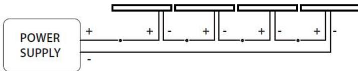
L'apparecchio funziona con un alimentatore a corrente costante (350mA max). Usare esclusivamente alimentatori appropriati. Il collegamento con altri apparecchi deve avvenire in serie e non in parallelo
