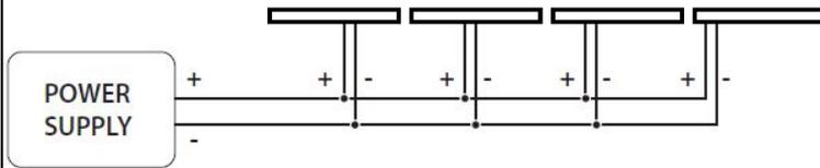
L'apparecchio funziona con un alimentatore a tensione costante (12-24V). Usare esclusivamente alimentatori appropriati. Il collegamento con altri apparecchi deve avvenire in parallelo e non in serie
